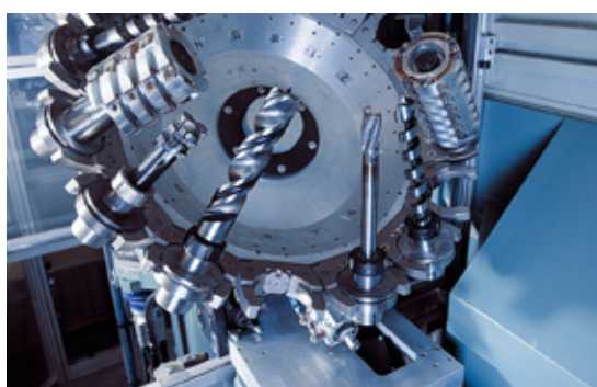
Abb. 8.05 Werkzeugmagazin einer CNC-Abbundmaschine
